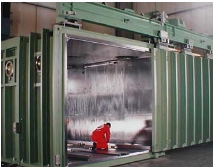
Vakuum- bzw. Arbeitskammer
