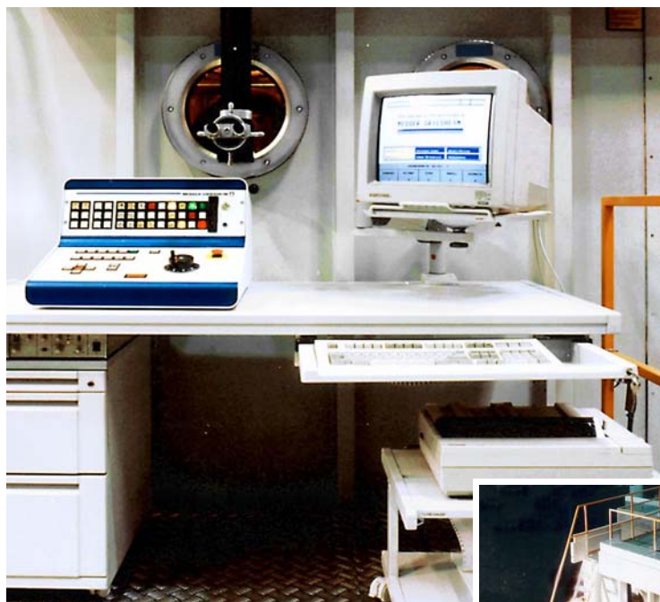
Bedienplatz VDU an einer EBOCAM Kammermaschine Typ K 100 – G 300 KM
