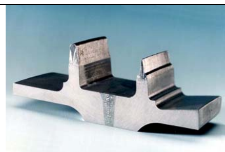
"Knife edges" in der Triebwerksreparatur
