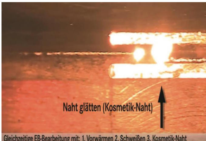
Bild 11: Die ersten beiden Strahle wärmen das Werkstück vor, da zwischen wird geschweißt und im Anschluss erfolgt eine Kosmetiknaht.
