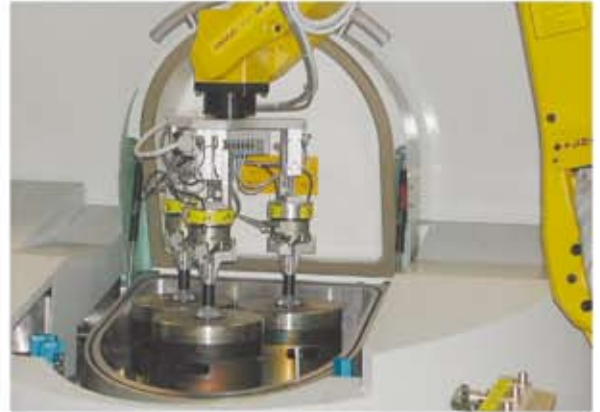
Загрузка деталей роторов в трехшпindelную установку
